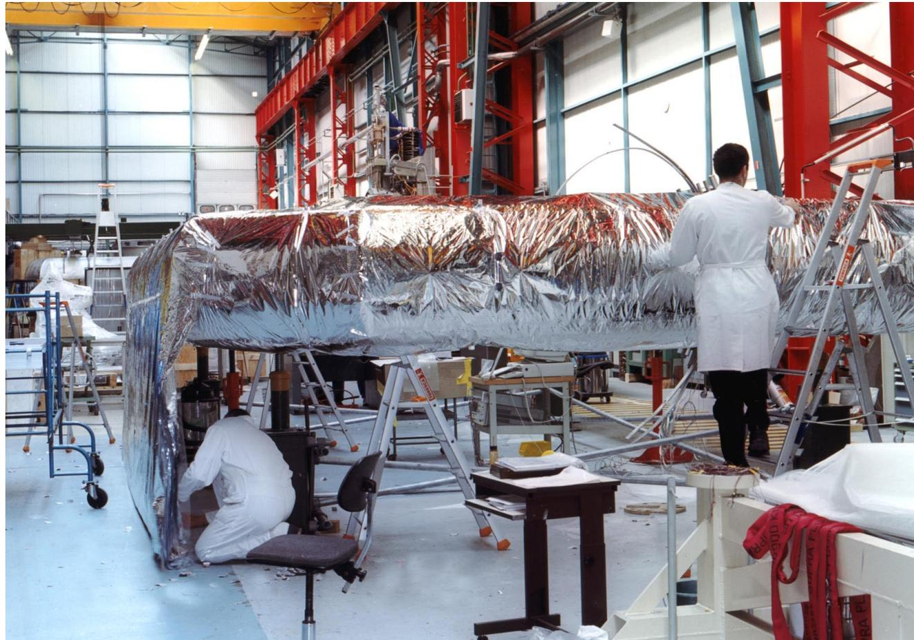
Mise en place de la superisolation sur l'écran thermique
